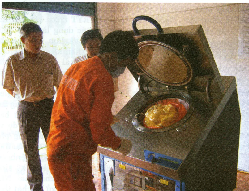
Thiết bị xử lý CTRYT bằng vi sóng kết hợp hơi nước bão hòa tại VietSov
