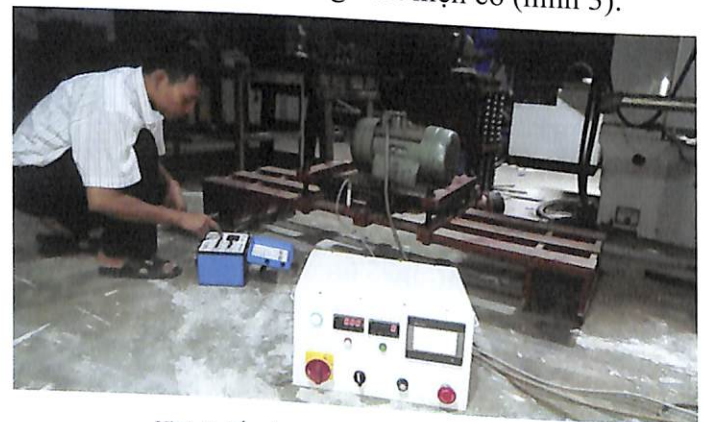
Hình 3: kết cấu cố gắn đầu rung khử ứng suất
