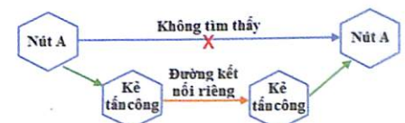
Hình 2: tấn công Wormhole
